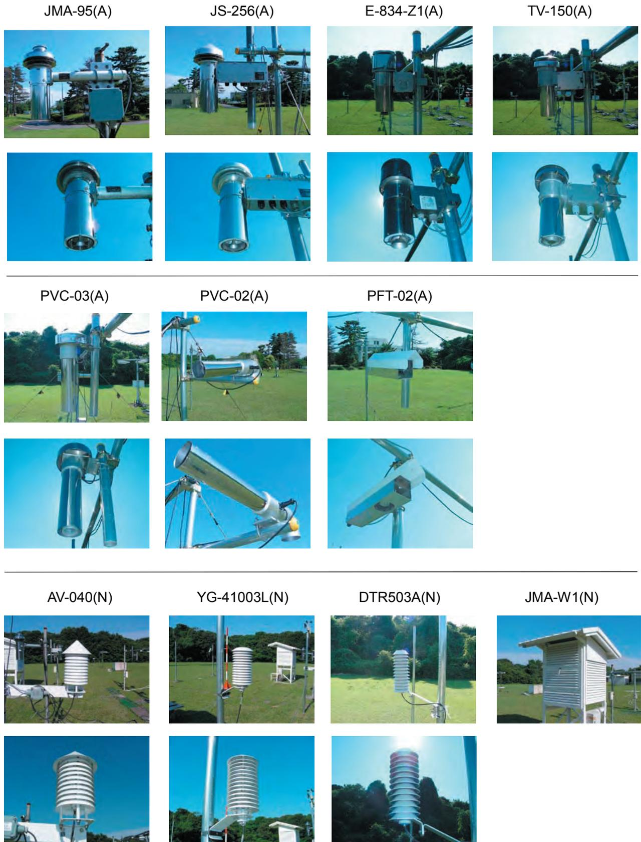
第2図 各種通風筒の写真（上：側面，下：下側から見上げて）
