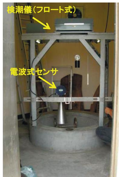
第18図 東京検潮所における電波式センサと検潮儀（フロート式）の比較試験の様子
