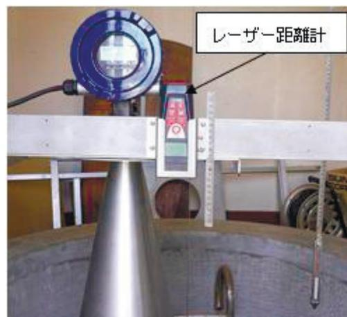
第 22 図 レーザー距離計による精度確認
