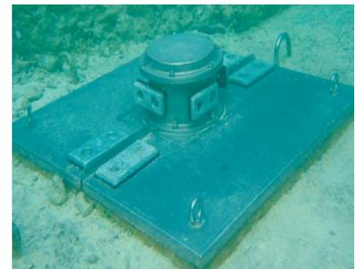
第 8 図 遠地津波観測計の模式図（左）、水圧センサの設置状況（右）
