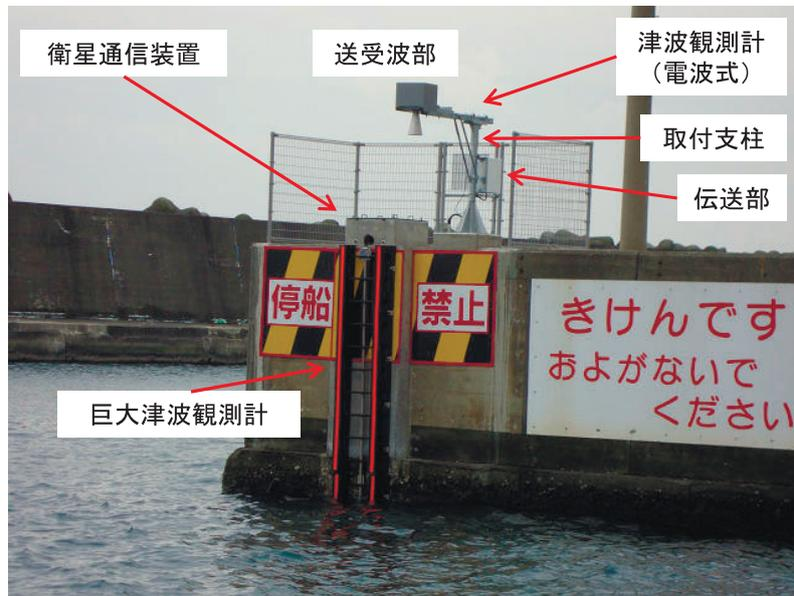
第 7 図 津波観測計（電波式）の設置状況
