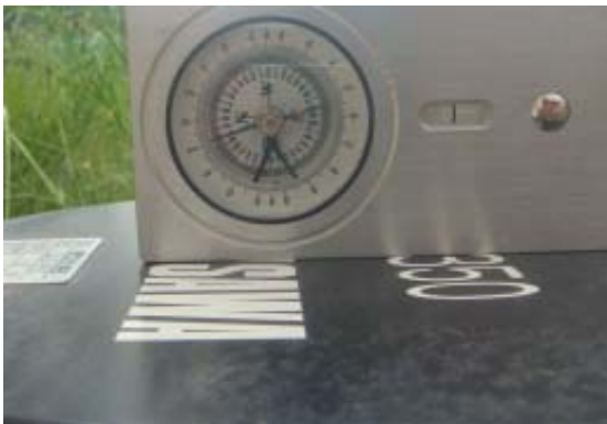
震度計は南方向が上位になって、約 2°傾いている。
