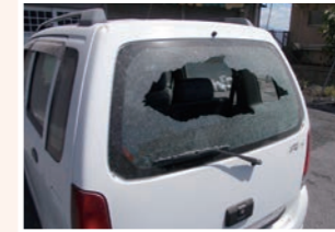
小さな噴石の落下で車の窓ガラスが破損
