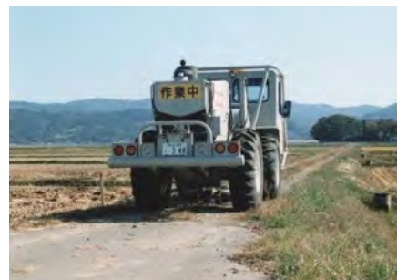
人工的に地面を揺らして、地下の構造を調査（山形県） 写真提供：山形県
