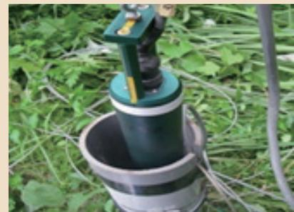
火口直下の熱水や火山ガスによる山体の膨張による傾斜変化を監視します。
