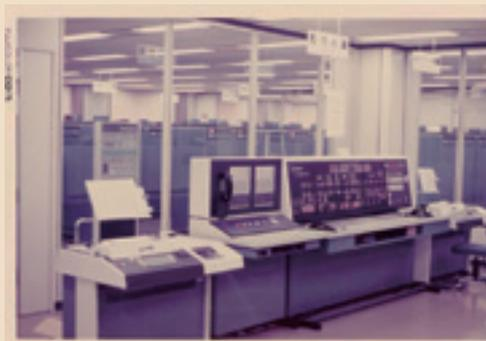
各観測所からのデータ収集状況やセンターシステムの稼働状況を監視するための端末装置。当時、センターシステム整備を担当した電電公社（現NTT）の建物内に設置され、気象庁職員が常駐して監視した。
